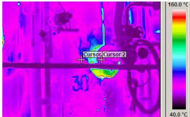
**Печь №2 ЦМИ-1.** Установлены теплоизоляционные экраны. Температура наружной стенки до 60-70 °С.
